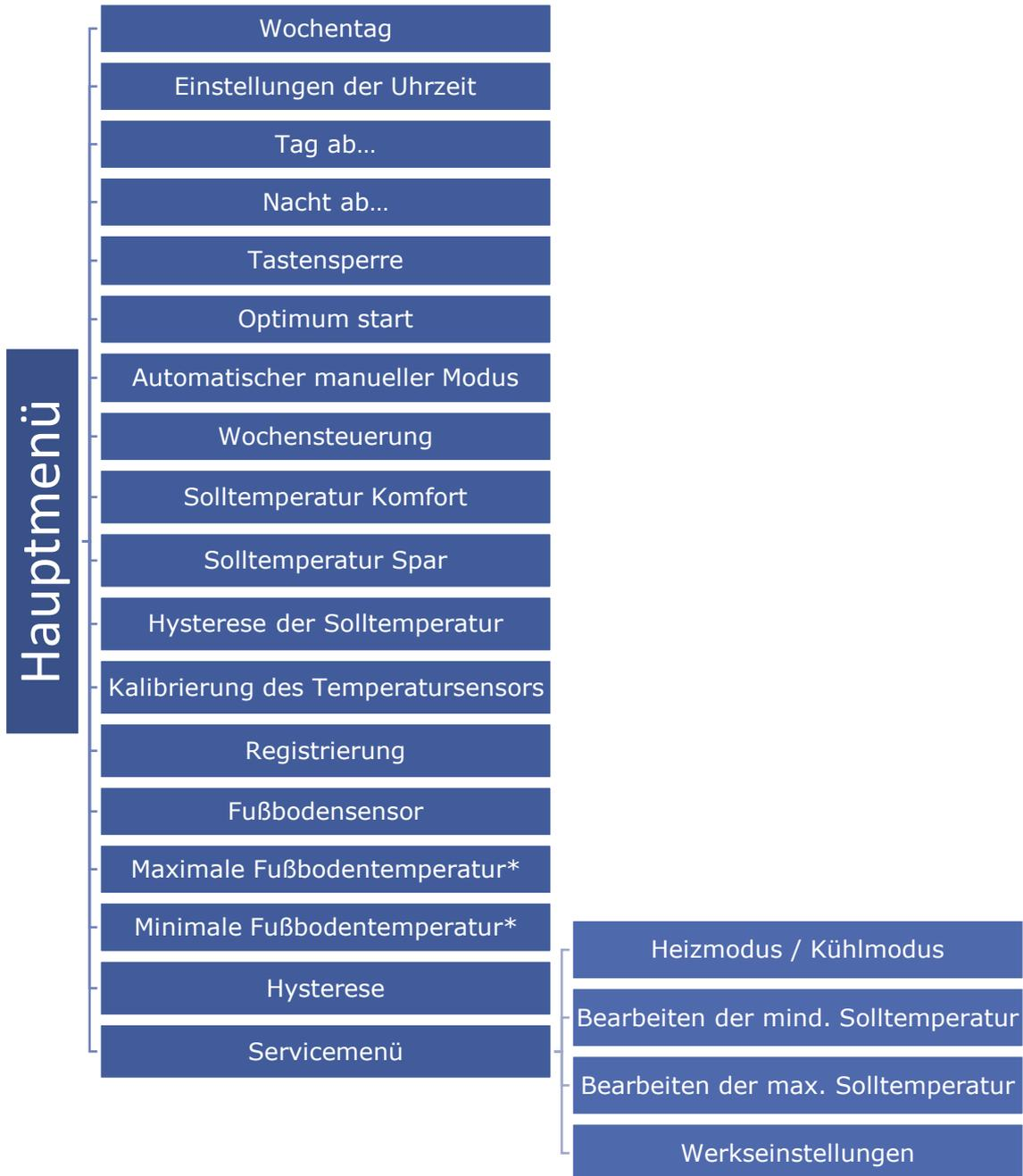
\*Die Funktionen sind im Menü erst nach der Aktivierung des Fußbodensensors aktiv – also nach Eindrehen des Zusatzsensors in den Kontakt des Fußbodensensors und der Markierung der Option AN im Untermenü des Fußbodensensors.
