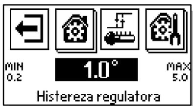
Hysterézia izbovej teploty zadáva toleranciu pre zadanú teplotu chrániacu pred nepožadovanou osciláciou pri minimálnom kolísaní teploty (v rozmedzí 0,2 ÷ 4°C).
