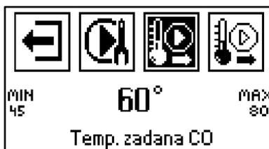
Táto funkcia dovoľuje zmeniť zadanú teplotu kotla (ÚK) v takom rozsahu aký obsluhuje regulátor kotla.
