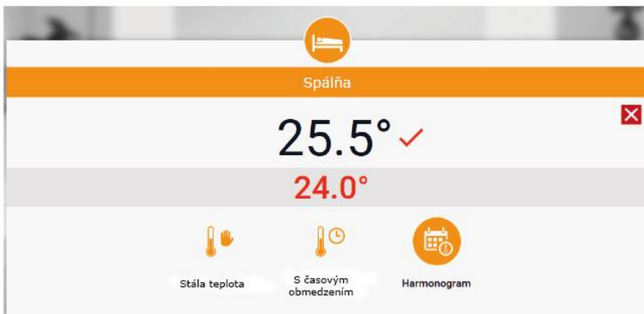
Panel pre zmenu nastavenia zadanej teploty v zóne a nastavenie harmonogramov.
